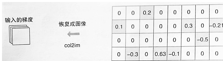
图 27 使用 col2im 函数将矩阵恢复为图像
